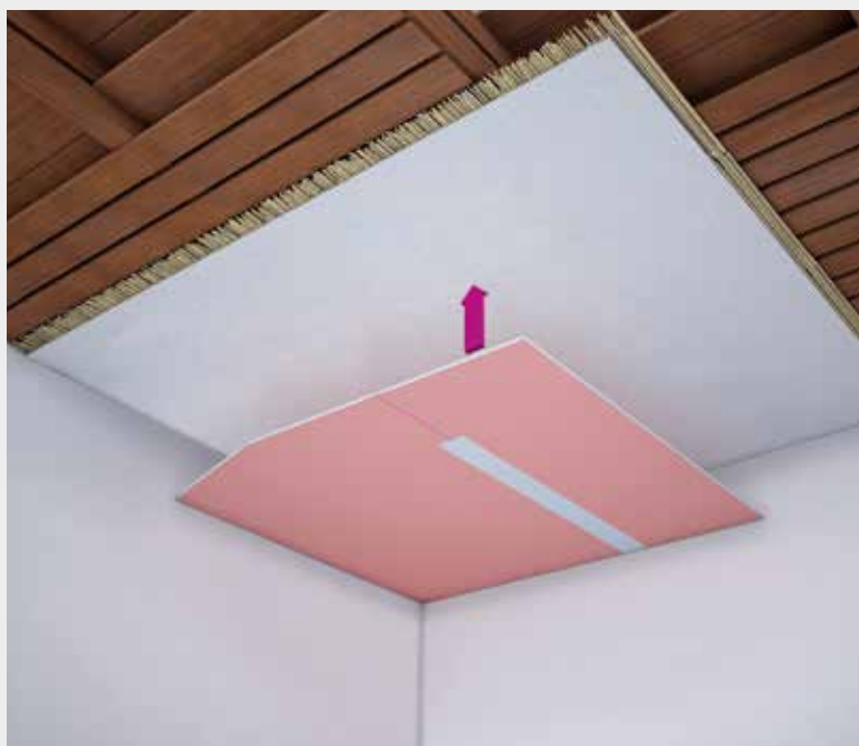
SD56 A1 – Direktbekleidung mit Flamtex A1 ohne Unterkonstruktion, einlagig
