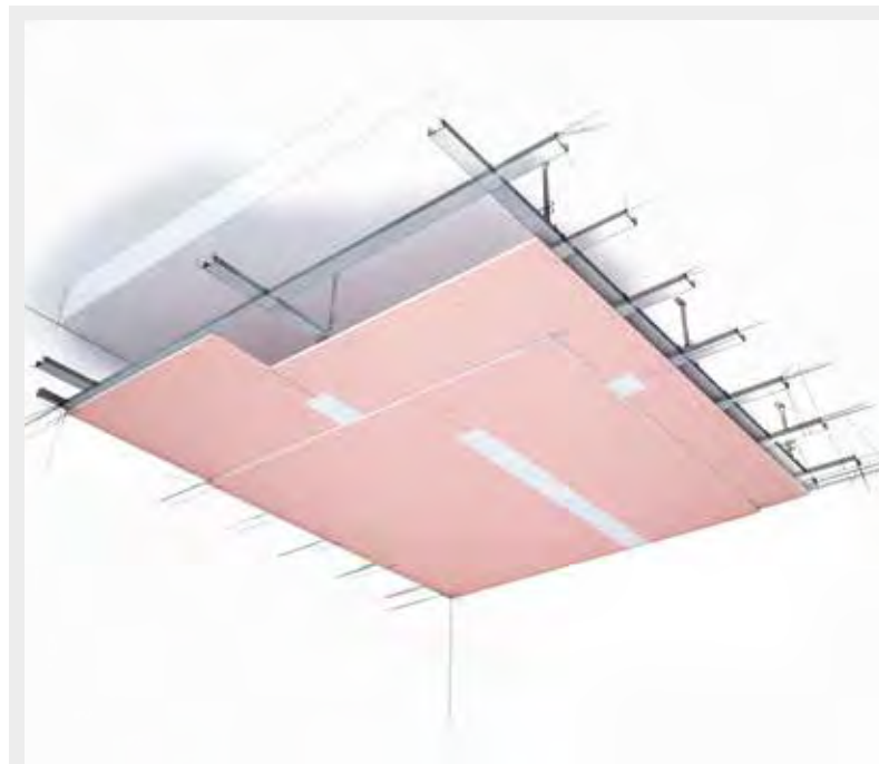
SD51-52 A1 – Unterdecke mit Grund- und Tragprofil und Flamtex A1
