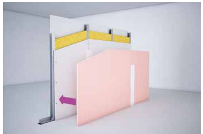
Einseitige Ertüchtigung mit Flamtex A1 und Siniat Fugenspachtel bei einseitiger Brandbeanspruchung
