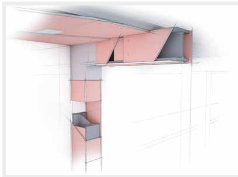
ST71-74 A1 – Stahlstützen- und Stahlträgerbekleidungen mit Flamtex A1
