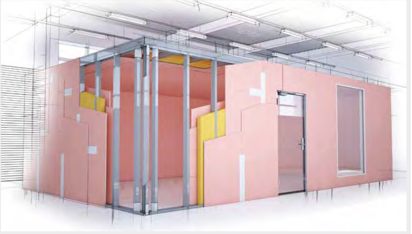
SK111 A1 – Brandschutzverglasungen im Raumsystem mit Flamtex A1
