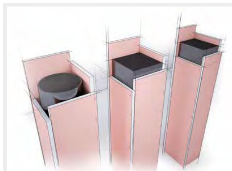
ST71-74 A1 – Bekleidung von geschlossenen Stahlhohlprofilen mit Flamtex A1
